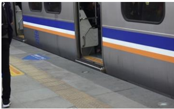
車廂無階化完成
